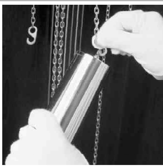
Bild 7 / Picture 7 / Figure 7 / Ilustración 7 Einhängen der Gewichte (Kettzugwerke) Hanging the weights (chain movements) Suspension des poids (mouvements à chaînes) Suspensión de las pesas (movimientos a cadenas)
